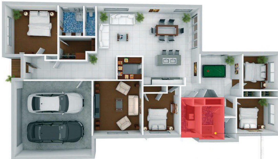
فضای ایجاد شده هنگام استفاده از دیوارهای WALLCRETE
